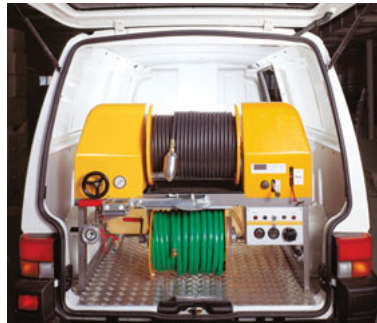
Figura 2. Máquina desastascadora con tuberías de alta y baja presión plásticas.
