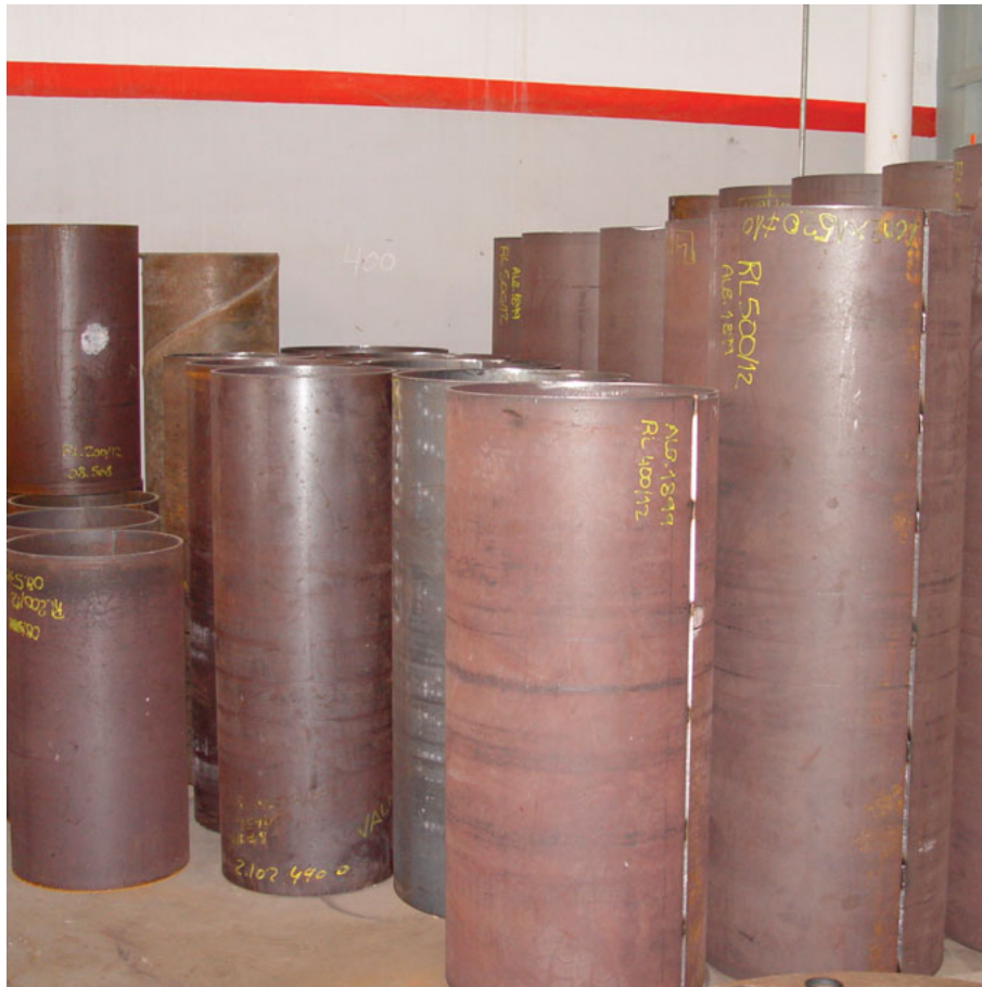
Figura 22. Virolas de chapa de acero enrolladas.
