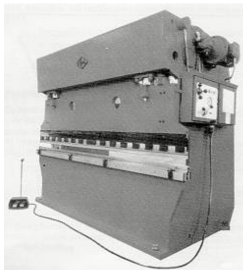
Fig. 1: Principales órganos constitutivos de una prensa plegadora
