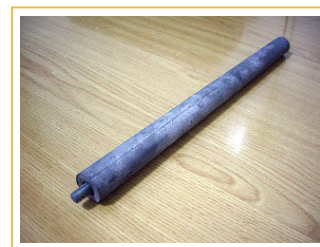
Fig.35: Ánodo de sacrificio de magnesio para acumulador de agua caliente.
