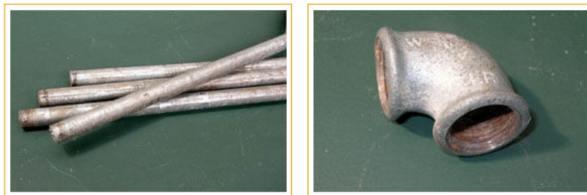
Fig. 34: Tubos y racor de acero galvanizado para conducción de agua.
